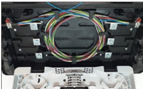
4.1.8 Coloque el tubo loose en las cavidades de fijación y haga una marca donde se enrollará para el sangrado.
