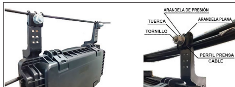
4.5.2 Para fijación en el cable de acero, utilice el conjunto de perfil de prensacable y los componentes metálicos (tornillo, arandelas y tuerca).
