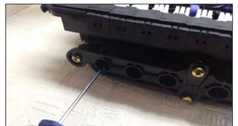
6.2. Perforar el grommet en la entrada de derivación.
