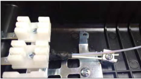
6.4. Fijar los elementos de tracción en la chapa de retención.
