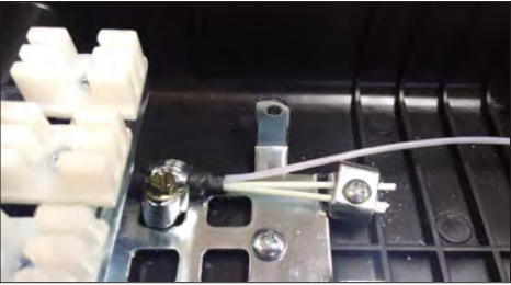
6.5. Fijar el cable en la base metálica con la abrazadera RSF de acero inox.
