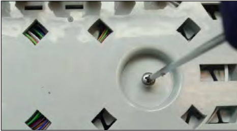
7.11. ATENCIÓN: Después de la utilización y colocación en la CTO-PLP-16, asegúrese de fijar las bandejas, utilizando el tornillo que se incluye en la caja.
