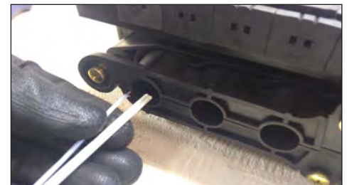
6.3. Introducir el CFOA de derivación en el agujero, pasando el elemento de tracción junto al tubo Loose.
