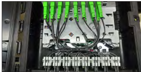
7.15. Ejemplo 4: Conexión completa con los 16 adaptadores conectados, según la composición del diagrama.
