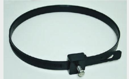
ce à tração, as **Cintas Dielétricas PLP** são ajustáveis a qualquer tipo de superfície, como consequência, a instalação torna-se prática e rápida, seja pelo sistema de trava com parafuso, que perfura a cinta ao ser apertado, ou pelo sistema de trava com ranhuras, que não exige nenhum tipo de ferramenta.
