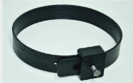
As cintas dielétricas têm a função de sustentação de acessórios em qualquer tipo de poste de redes aéreas, tais como postes circulares, duplo T, entre outros. As cargas de ruptura variam entre 200 e 750 daN, dependendo das espessuras dos diferentes modelos disponíveis, e são recomendadas para vãos de até 200 metros.
