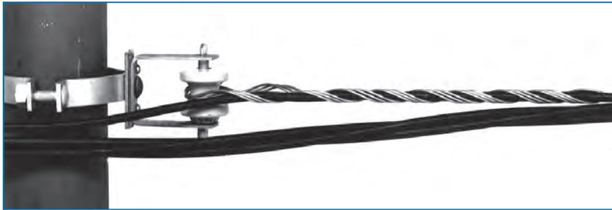
La Retención Preformada - SG/DG se destina al anclaje del conductor con neutro aislado ó recubierto de los cables preensamblados en la entrada al consumidor ó en las redes de distribución. Se aplica directamente sobre el aislador roldana.
