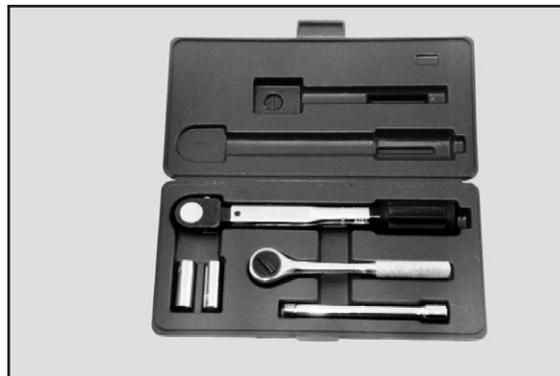
**Figura 5 - Llave de crique, torquímetro y prolongadores**
