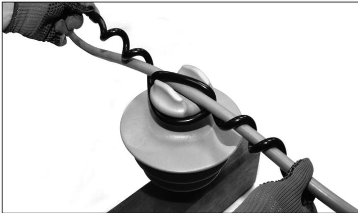
**5.** Aplique a outra perna do Laço. Pressione levemente com o polegar as pontas do Laço para terminar a aplicação sobre o condutor.
